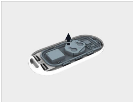
Иллюстрация: снятие печатной платы ключа дистанционного управления
