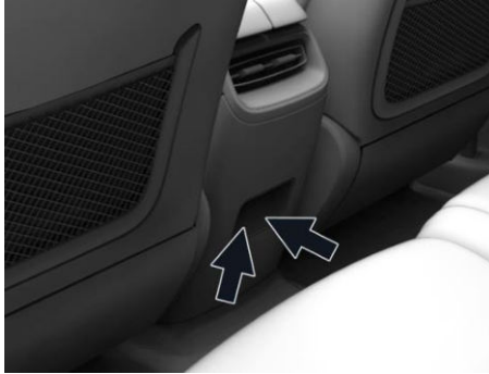
Иллюстрация: расположение розетки питания Type C на передней вспомогательной приборной панели на заднем ряду
